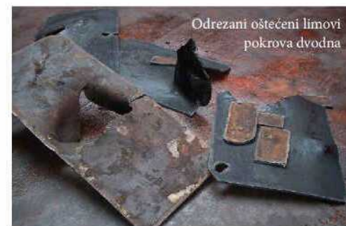
Oštećenje dna na oplati broda
